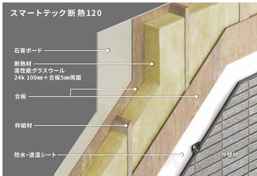
再面の合板で断熱材をパネル内に閉じ込めたミサワホームオリジナルの断熱工法により、限られた断熱材の厚みで断熱等級6に対応した「スマートテック断熱120」
