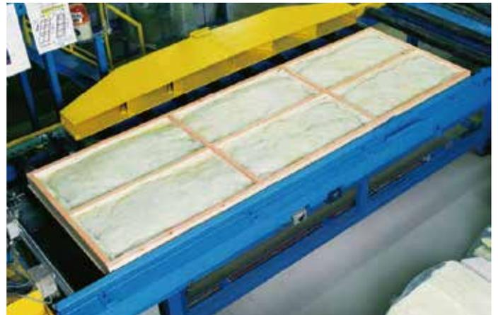
工場で高精度に仕上げる「木質パネル」。断熱材をすき間なく充填し、内部は枠組材によって格子状に仕切られているため、経年と共にずれたり、ムラができる心配がありません。高断熱を長期間維持します。
